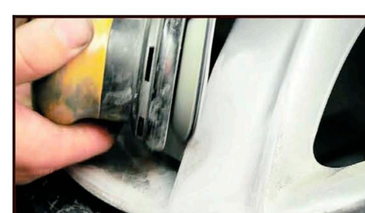
**SLIPEBENKEN:** Med en luftdrevet slipemaskin og spesielle pads slipes den verste delen av skaden vekk i godset. Eker med kunstferdige profiler er ikke alltid like lett å fikse, men denne var enkel.
