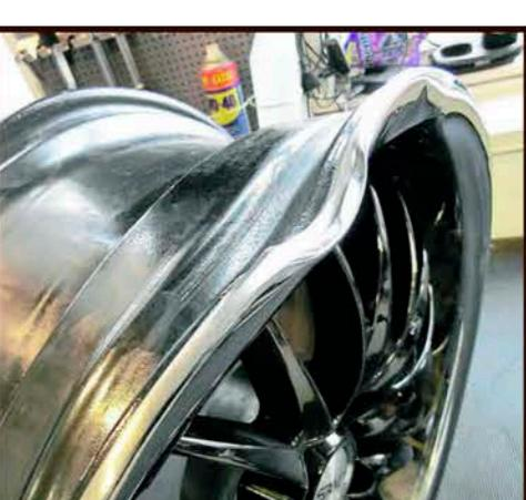
**EKSTREM-TILFELLE:** Selv om skadene blir så omfattende som dette, er det fortsatt håp, med ekspertise og maskiner som sørger for en trinnvis utbedring av omfattende skader. Manglende biter kan sveises på. Den endelige finshen gjøres gjennom diamantkuttemaskin. Foto: ØSTFOLD FELGETEKNIKK AS
