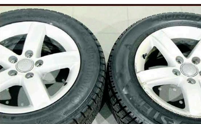
**FELG FIKS FERDIG:** Felgen (til venstre) er nå ferdig. Felgen til høyre var mindre skadet og venter på tur for samme behandling.
