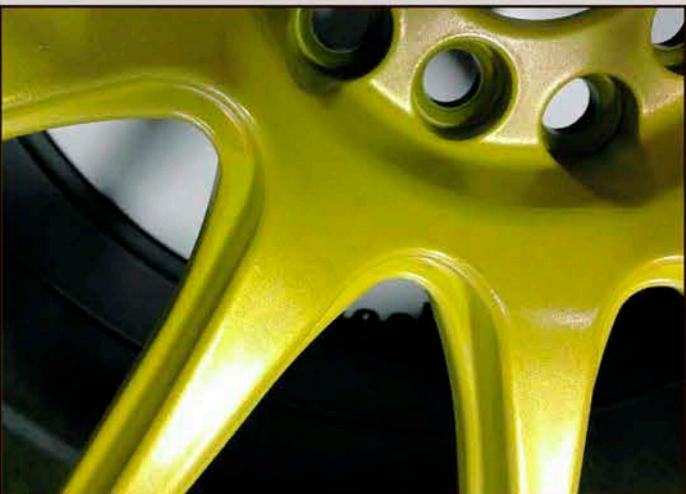
**GUMMI:** De som har litt trening med gummispray sier den er svært enkel å påføre. Man trenger knapt maskere, fordi overflodig spray kan rives vekk etter det er tørt.
