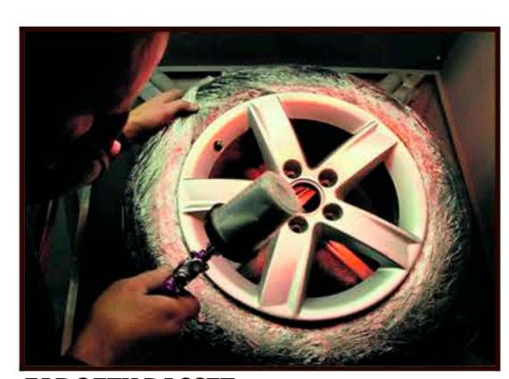
**FARGETILPASSET:** Hjulet er flyttet over på lakkbenken. Lakkuløper matches den opprinnelige fargen. Spraytepistolen er et presisionsverktøy med utrolig treffsikkerhet.
